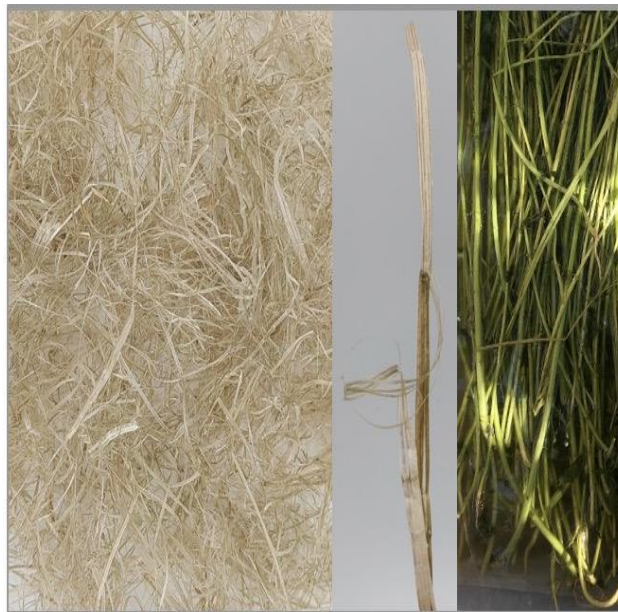
Proceso de extracción de la fibra Enriado en agua
