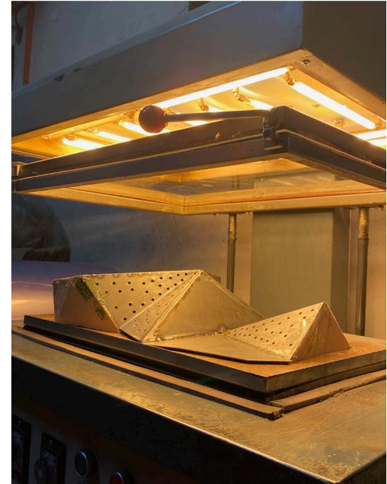
La primera prueba que se hizo fue con una matriz de lata y con acrílico. El error que se cometió fue que al calentar el acrílico en la parte superior de la máquina, al momento de bajar y succionar, destruyó por completo la matriz por no tener una superficie de contacto dura y rígida además por ser un material delgado y liviano. Se decidió a hacer la matriz de nuevo de lata pero esta vez con una superficie de apoyo de yeso.
