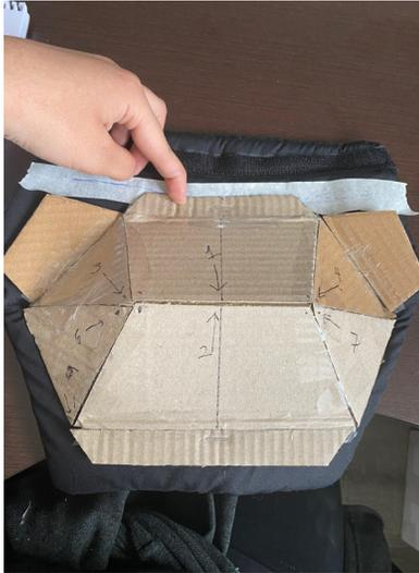
Se realizó también una matriz para las zonas íntimas y la primera capa de absorción con tela y espuma. Se procedió a geometrizar la zona y se prototipo con cartón. Esta estructura se apoya en la superficie blanda acolchada mediante 4 puntos de apoyo que van remachadas generando así que el volumen de la estructura no vaya a ras de la superficie negra disminuyendo la superficie de contacto y generando que la fuerza se disperse por esos 4 puntos.
