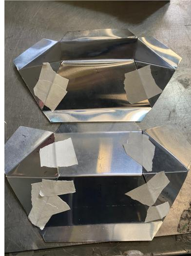
Luego se hizo una matriz de lata con un respaldo de yeso y se metió a la máquina de termoformado para probarlo con acrílico.
