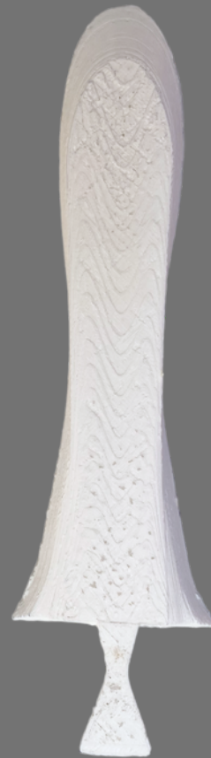
Prueba 4 Muy larga Queda mal en 2 partes
