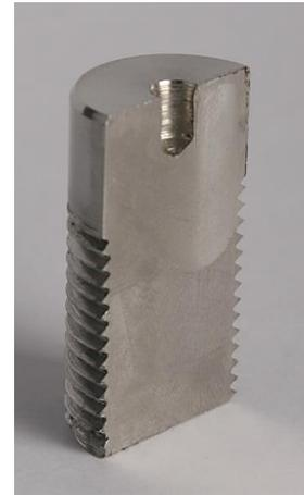
FIGURA 8. Cilindro metálico con perforación de 4mm x 8mm
