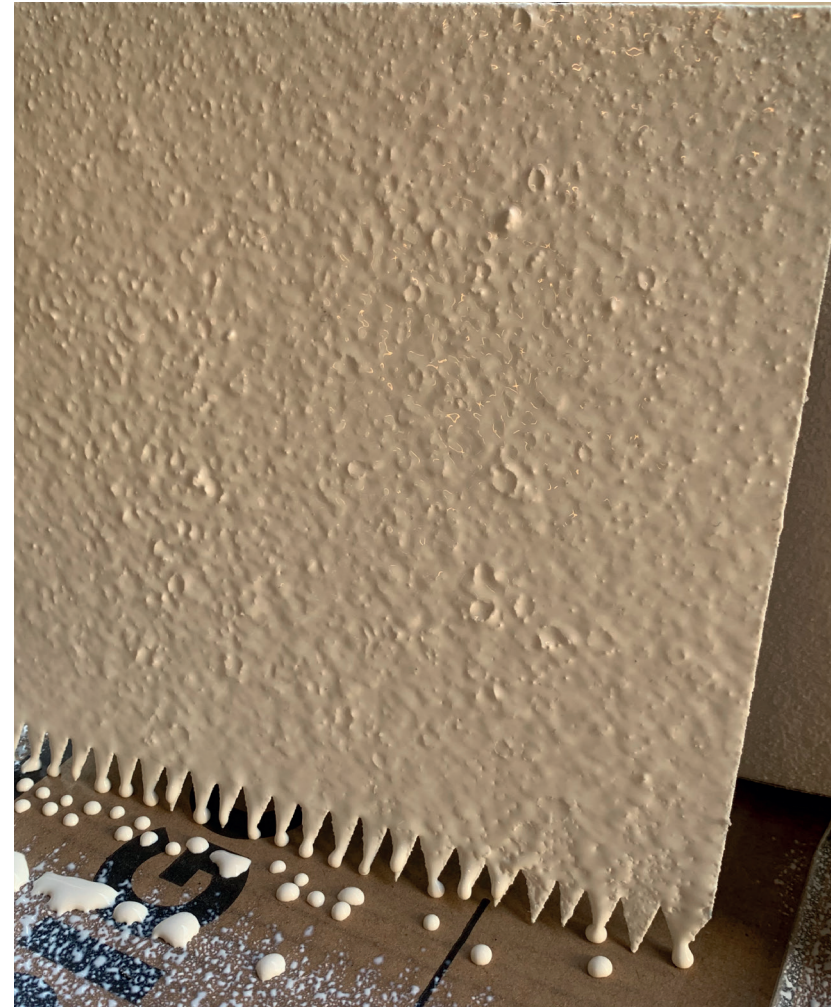
Figura N°78. Revestimiento de placas con Caolín y acrizinc. Generan un acabado poroso gracias a la pistola electrica. Elaboración propia
