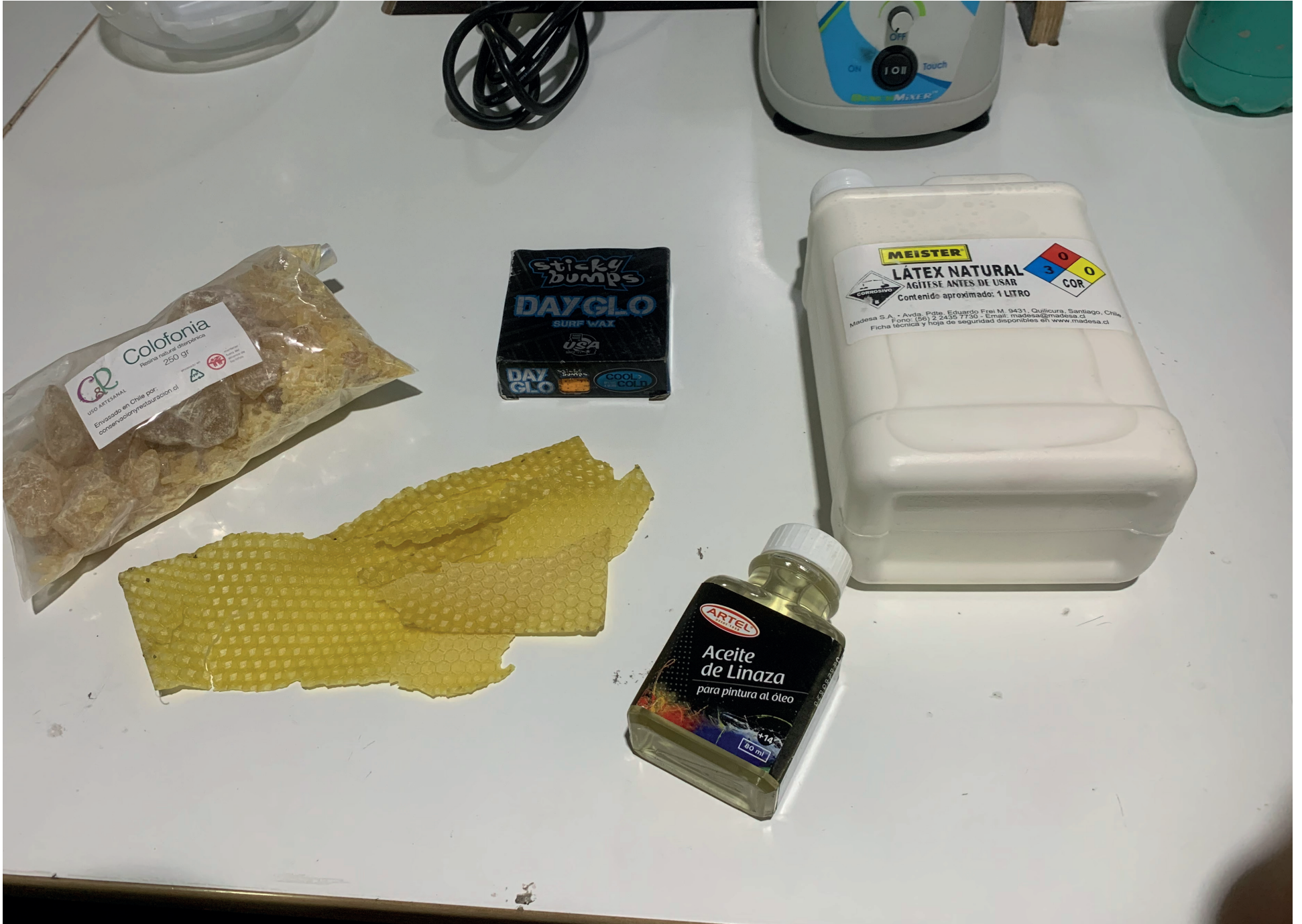
Figura N°36. Materiales que serán analizados en la prueba de ángulo de contacto.
