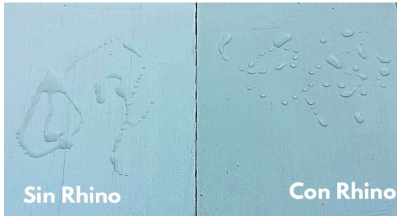
Figura N°23. Comparación de superficies con y sin tecnología Rhino. Recolectión de agua atmosférica: una revisión de los diseños de materiales y estructuras.
