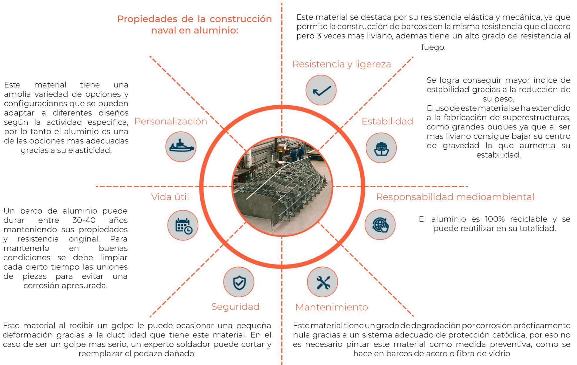
Figura 54: Elaboración propia / Propiedades de la construcción naval en aluminio.
