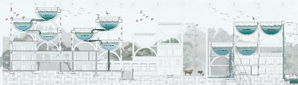
CORTE LONGITUDINAL INSTALACIONES HIDRAULICAS ESCALA 1:150
