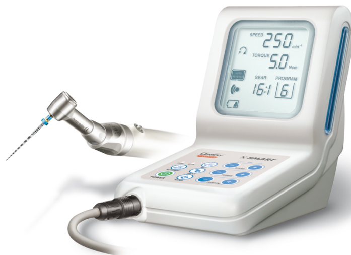
Figura 10. Motor de endodoncia X-Smart™ Plus (Dentply Malliefer, Switzerland). Seteado a una velocidad de 250 rpm y un torque de 5.0 Ncm con rotación continua y auto reversa en caso de alcanzar el torque.
