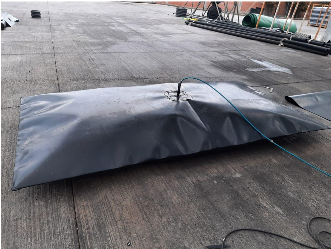
Imagen 1. Fotografía del tanque reactor de geomembrana de HDPE.
