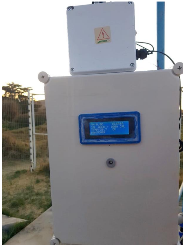
Imagen 22. Fotografía de la estación de monitoreo (caja estanca, visor LCD, luz led y Router).
