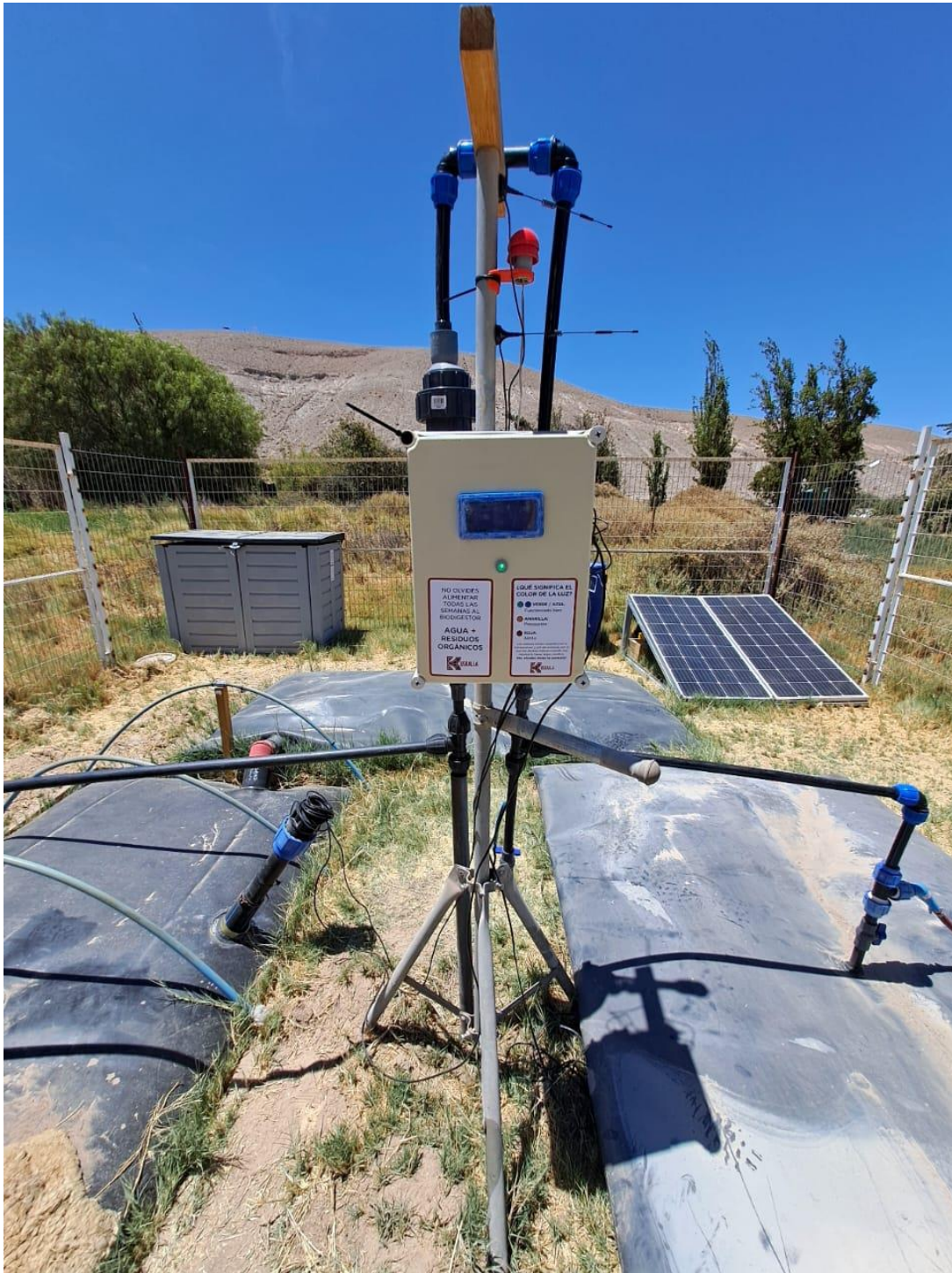
Imagen 23. Fotografía de la estación de monitoreo (caja estanca, visor LCD, luz led y Router).
