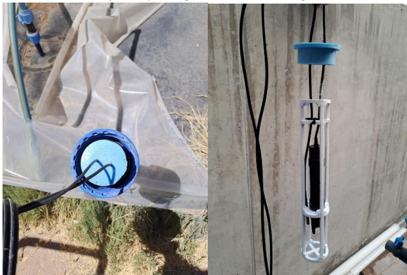
Imagen 8. Fotografías del soporte de sondas y tapón de silicona.
