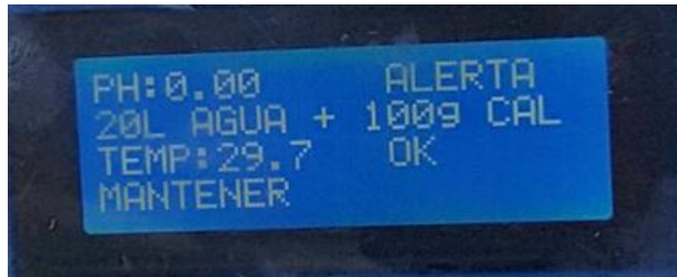
Imagen 21. Visor de pantalla LCD para visualización de datos en terreno, Mamiña.
