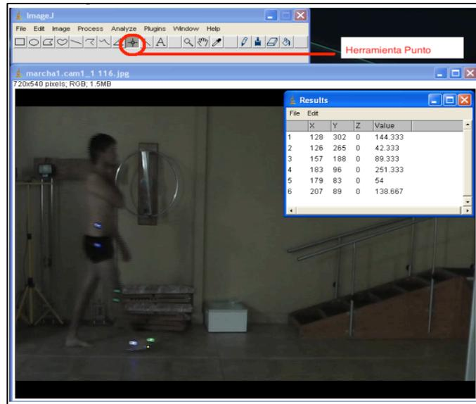
Figura A1.5: Identificación de coordenadas desde fotograma seleccionado. Imágenes generadas por Equipo Docente de Biomecánica UDD para enseñanza en el uso de software libre con fines académicos.
