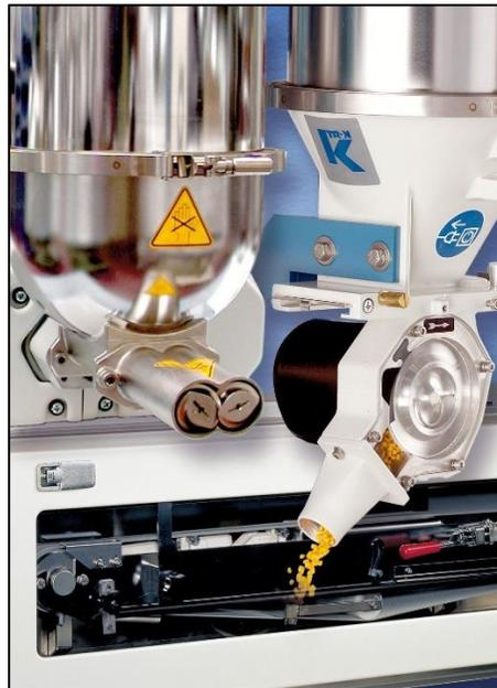
Figura 12: imagen referencial dosificador gravimétrico
