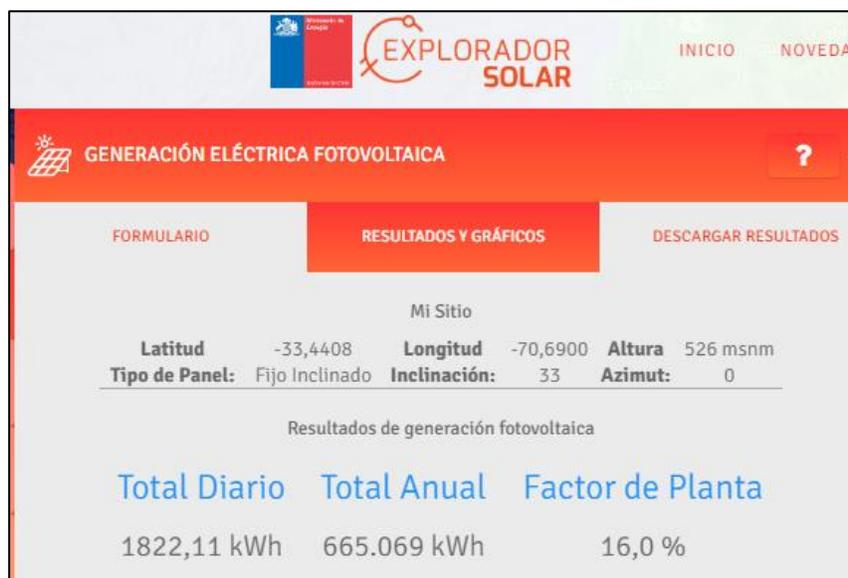
Figura 31: Resultados simulación sistema fotovoltaico Ministerio de Energía
