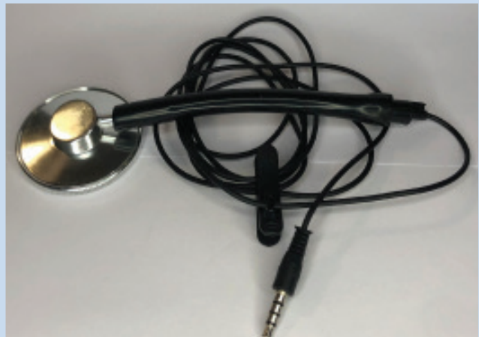
[Fig. 56] Prototipo con micrófono omnidireccional - elaboración propia
