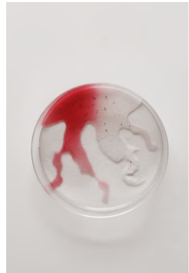
Figura 4.32: Hidro gel en carbonato de calcio y polisacrido. Los plastos mas el hidro gel, generan un componente que al estar en contacto con el ambiente forma un tejido similar a la piel y los músculos, teniendo un nivel de rigidez mayor al anterior (fluido) y poder tomar variadas formas según las normales de dirección.
