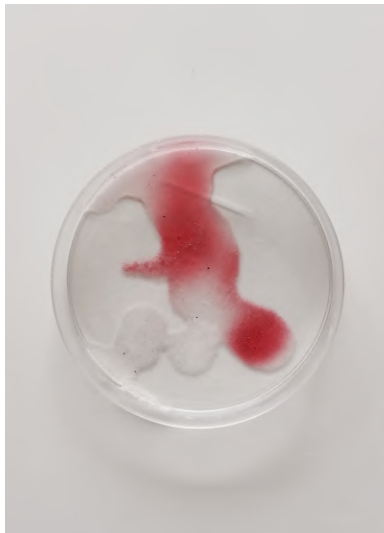
Figura 4.32: Hidro gel en carbonato de calcio y polisacrido. Los plastos mas el hidro gel, generan un componente que al estar en contacto con el ambiente forma un tejido similar a la piel y los músculos, teniendo un nivel de rigidez mayor al anterior (fluido) y poder tomar variadas formas según las normales de dirección.
