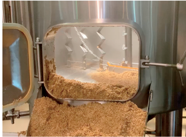
El macerador tiene aspas que rotan en el interior que ayudan a que el bagazo salga.
