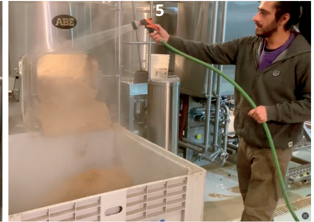
Mientras el bagazo cae al bin, con una manguera limpia superficialmente el macerador.
