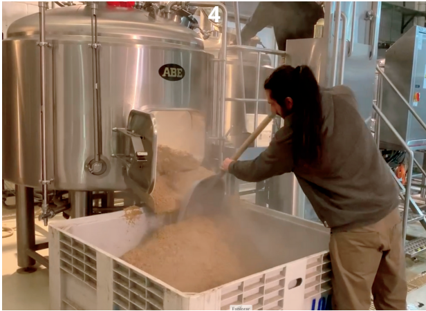
Con la ayuda de una pala esparce el bagazo en el bin ya que se acumula en la caída.
