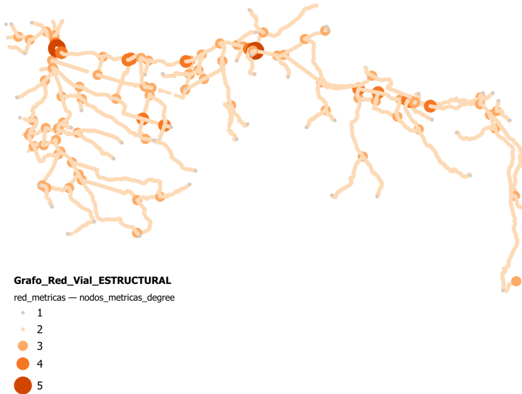
Figura 23a. Grado de centralidad que muestra la cantidad de conexiones por cada nodo de la red vial estructural.
