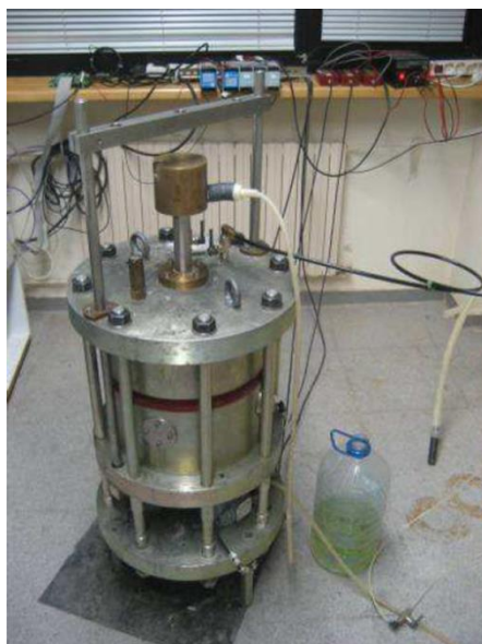
Figura 16. Edómetro utilizado para la ejecución de pruebas de compresibilidad, NFU's troceados
