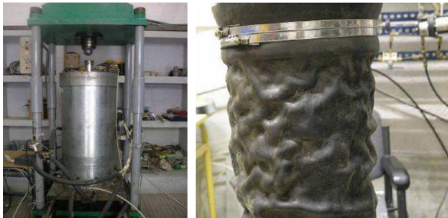
Figura 14. Equipo triaxial y probeta de ensayo, para pruebas en NFU's troceados
