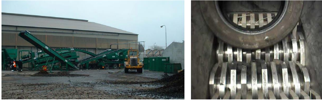
Figura 8. Planta y máquina para la trituración de NFU's
