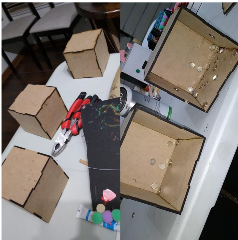
Fig. N° 20: Fabricación segunda iteración de personalización, los cubos de madera fueron armados y los imanes instalados en el interior, Elaboración propia.
