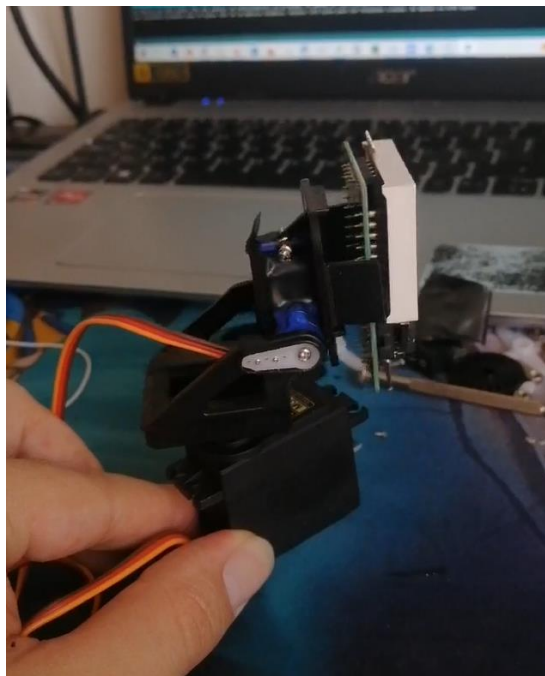
Fig. Nº 32: Testeo funcionamiento, segunda iteración “cuello”, nuevo display más firme y servo inferior más potente, matriz instalada, elaboración propia.
