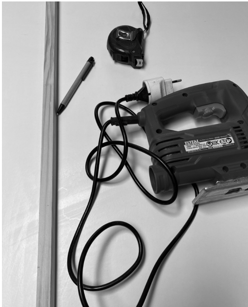
Herramientas para fabricar bastidor de melamina, el cual será utilizado como molde.
