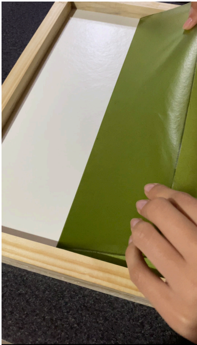
Desmolde de la lámina biotextil lista.
