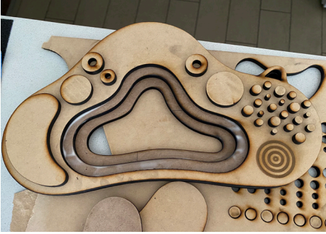
Este prototipo se hizo a través de corte láser y se unió con colafría para madera.
