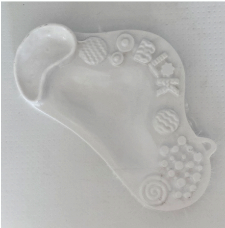
Una vez finalizado el prototipo mencionado arriba, se llevó al taller de herramientas de la UDD y con la máquina de termoformado se adherió una plancha del material pai para crear el negativo.
