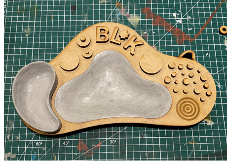
Luego con plasticina industrial se relleno las partes con profundidad.
