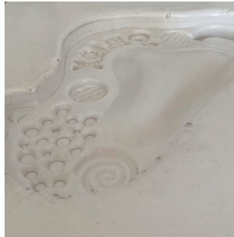
Una vez finalizado el prototipo mencionado arriba, se llevó al taller de herramientas de la UDD y con la máquina de termoformado se adherió una plancha del material pai para crear el negativo.
