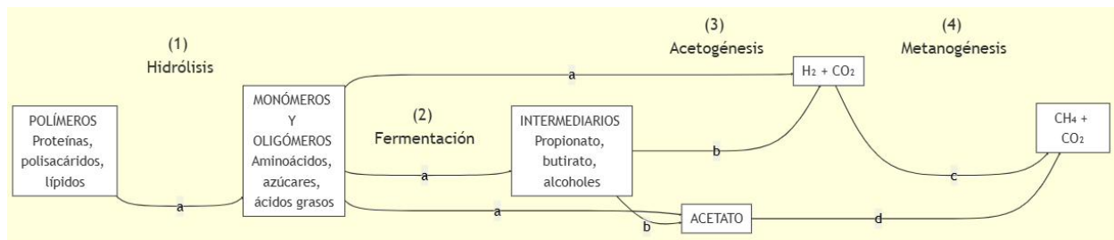
Figura 2.1: Diagrama esquemático del proceso de digestión anaerobia. Diferentes grupos tróficos: (a) bacterias fermentativas, (b) bacterias acetogénicas, (c) arqueas metanogénicas hidrogenotróficas, (d) arqueas metanogénicas acetoclásticas. Fuente: elaboración propia.
