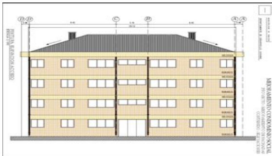
Ilustración 42: Block tipo 1010 con alero de H.A de proyección de losa de H.A. Fuente: Elaboración propia.
