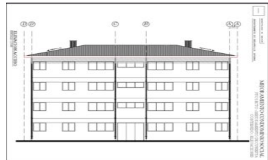
Ilustración 43: Block tipo 1010 con alero simple de cerchas proyectadas. Fuente: Elaboración propia.
