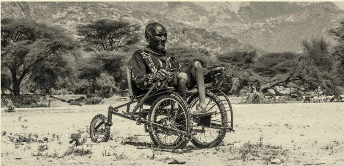
FIG.2 Un usuario prueba el primer prototipo de safariseat propulsado por palanca con un chasis articulado que actúa como mecanismo de suspensión en terrenos irregulares.
