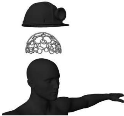
⤴ Muestra el sistema para ubicar los electrodos en la cabeza de una persona. Fue desarrollado por la empresa Open BCI.
