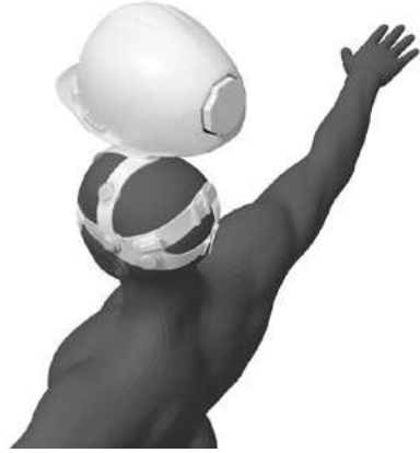
⤴ Muestra el diseño de una nueva banda de seguridad propia de un casco de minería. Que a su vez, permite ubicar los electrodos en la cabeza del operario. Autor: Dante Crovetto.
