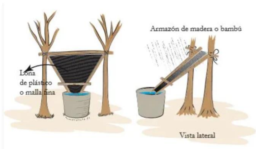
Figura N°11. Captación con Lona triangular (fuente: Cosecha de agua Lluvia, Guía práctica, 2021).
