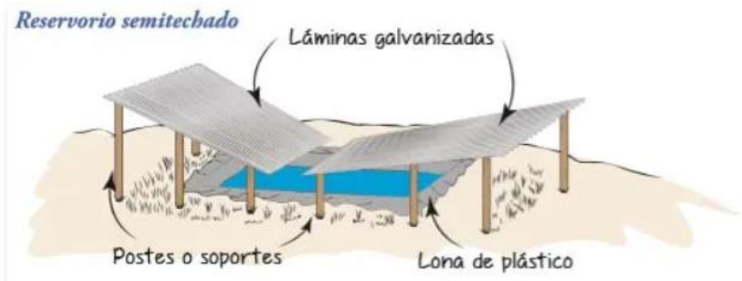
Figura N°10. Reservorio semitechado (fuente: Cosecha de agua Lluvia, Guía práctica, 2021).
