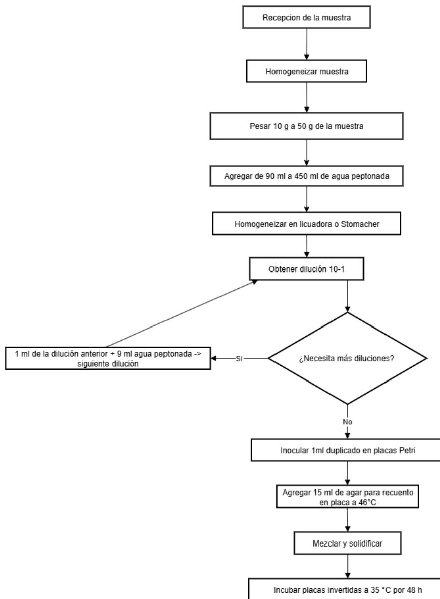
Figura 2. Técnica de recuento en placa para la determinación de microorganismos aerobios mesófilos a 35 °C.
