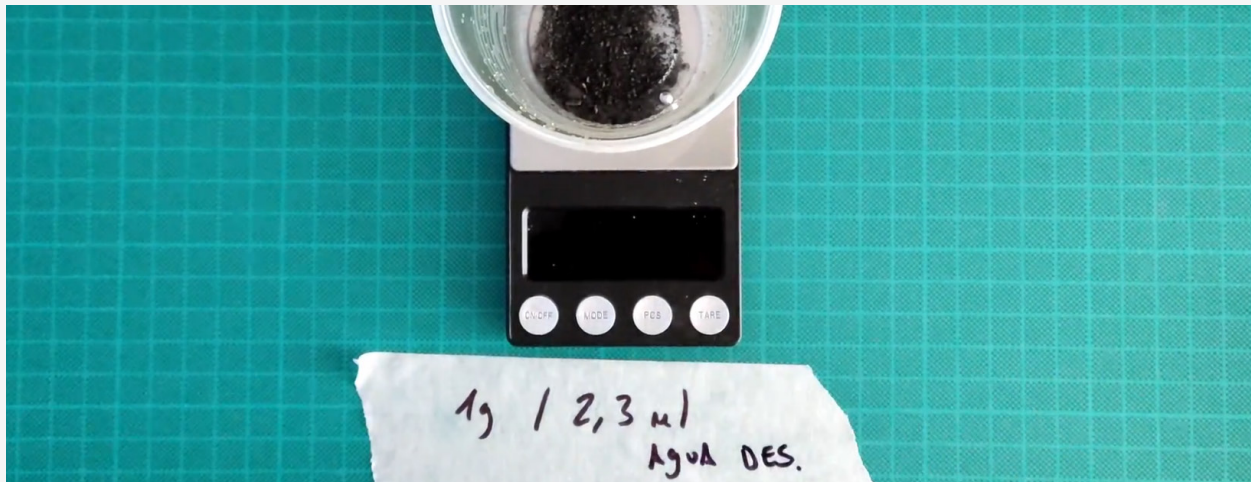
Imágen. Detalle del proceso de elaboración de revestimiento de grafito para experimentos, creación del autor.
