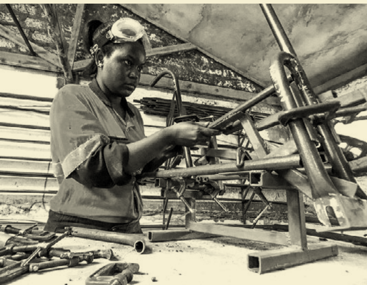
FIG.7 Utilización de una plantilla para colocar con precisión los componentes del bastidor en preparación para la soldadura.
