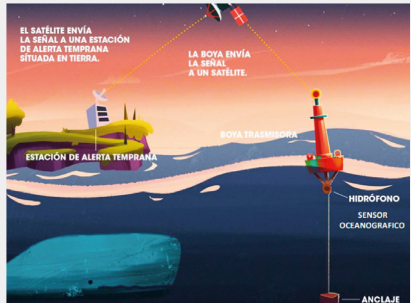
boya inteligente para evitar colisión de ballenas
