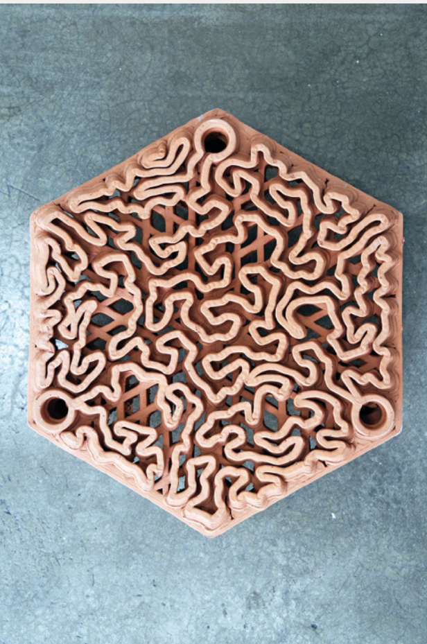
Restauración ecológica de arrecifes mediante la impresión de arcilla en 3D
