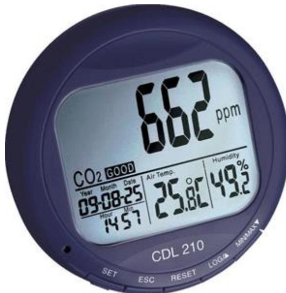
SENSOR CO<sub>2</sub>: Mide contenido de CO<sub>2</sub> mediante infrarrojos, la temperatura y la humedad del aire.
